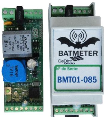
Medidor monofásico para conexión en cuadro eléctrico, con medida de consumo desagregado (kWh y potencia) hasta en seis líneas con salida 6LowPAN (sobre IPv6).
