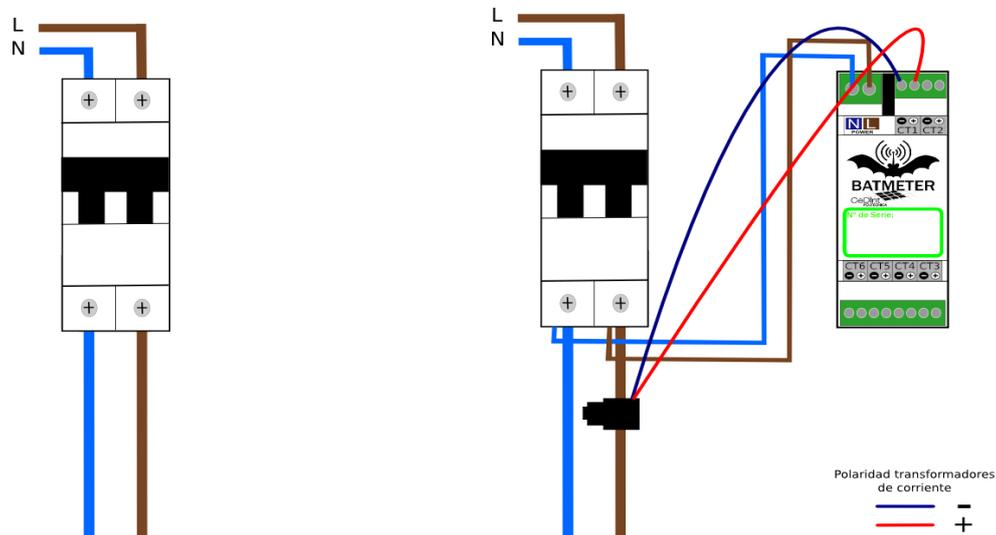
*Ilustración 1: Aspecto del conexionado de un PIA en el cuadro eléctrico, antes de la instalación del BatMeter*
